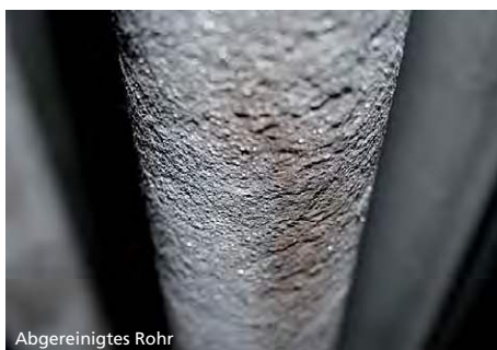
Bild 6: Vergleich der Rohroberfläche von Überhitzerrohren, die ohne (links) und mit (rechts) schützendem Belag wieder in Betrieb gegangen sind
