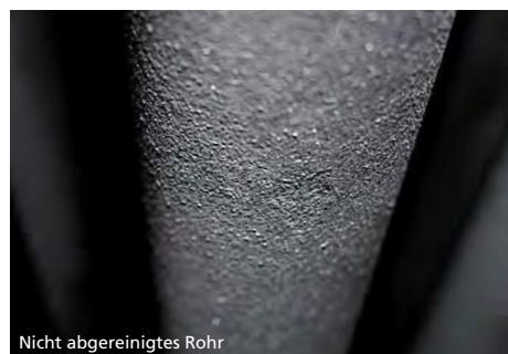
Bild 6: Vergleich der Rohroberfläche von Überhitzerrohren, die ohne (links) und mit (rechts) schützendem Belag wieder in Betrieb gegangen sind
