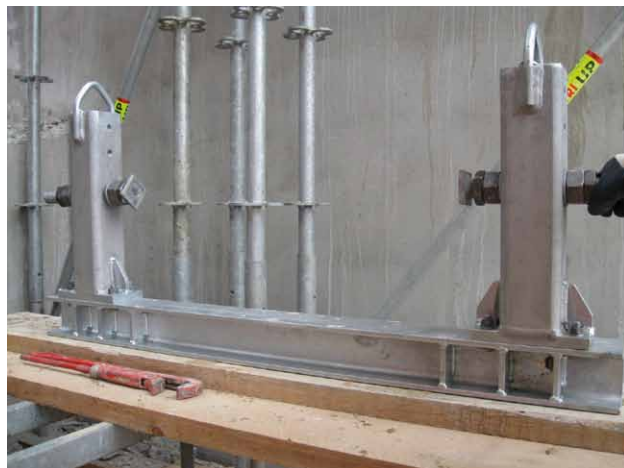
Bild 12 u. 13: Einhängekonsole: Auf dem Kopf liegend und im Einbauzustand mit angehängter Trägerkonstruktion der Gerüstarbeitsplattform
